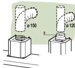
При монтаж на аспиратора в аспирираща версия, свържете аспиратора към комина, използвайки твърд или гъвкав въздуховод с диаметър Ø 150 или 120 mm, чийто избор е оставен на монтажника.
