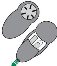
Апаратот може да се контролира со помош на далечински управувач со 1.5 V алкални батерији од стандарден тип LR03-AAA (не се вклучени).
