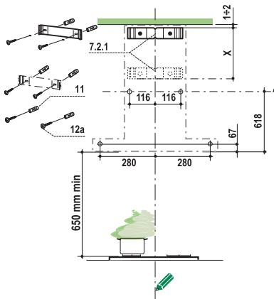
**Napomena:** Ukoliko se montaža donjem nosaču **7.2.1** na bilo koji način meša sa montažom nadstrešnice aspiratora, donji nosač **7.2.1** se može izostaviti.
